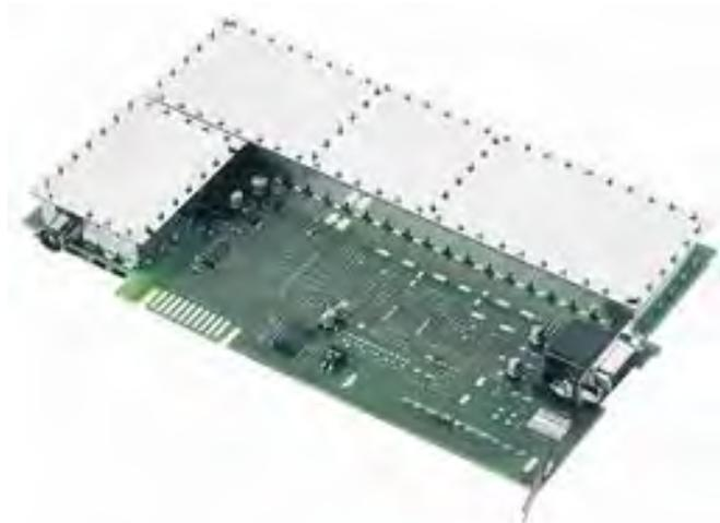
**ТСМА 673/674** – это модуляторы аналоговых А/V сигналов для головной станции ТСН 600, они предназначены для формирования из низкочастотных сигналов аудио и видео - высокочастотного сигнала на заданной частоте для передачи в кабельную сеть.
