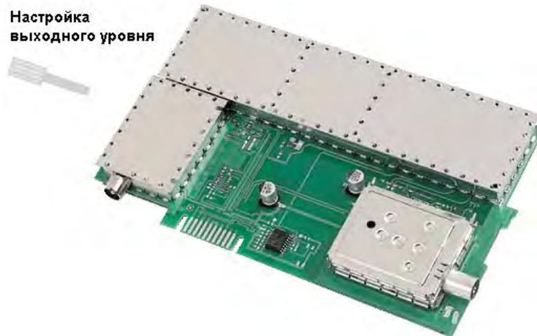
Для установки модуля ТССС 677 в шасси головной станции ТСН 600 необходимо с помощью инструмента расширить слот для подключения кабеля от антенны.
