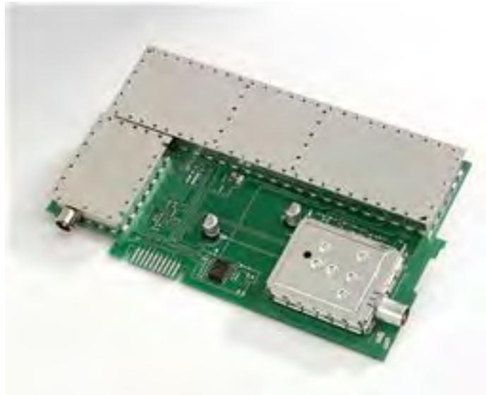
**ТССС 677** – это одноканальный конвертер аналоговых сигналов для головной станции ТСН 600, он переносит эфирный ТВ канал с одной частоты на другую, для передачи в кабельную сеть.
