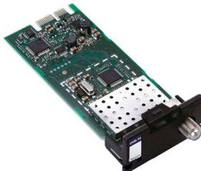
**Модуль DVB-T/T2** – предназначен для приема цифровых эфирных сигналов как стандарта DVB-T так и DVB-T2, устанавливается в секцию для входных модулей (верхняя часть) в головной станции TRIAX TDX. В одно базовое шасси можно установить 16 таких модулей.
