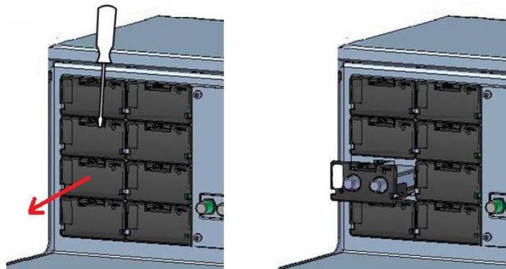
Для установки нужно снять защитную крышку с любого выбранного свободного слота и установить в него модуль до срабатывания фиксатора.
