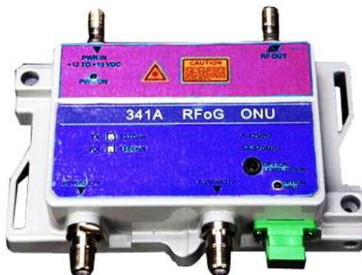
RFoG (RF over Glass) является технологией, которая позволяет кабельным операторам предоставлять услуги с применением пассивной оптической сети PON (Passive Optical Network). С использованием инфраструктуры головной станции и стандартов передачи РЧ в прямом и обратном каналах, кабельный оператор имеет возможность предоставлять услуги Triple Play аналогичным образом, как в сетях HFC.
