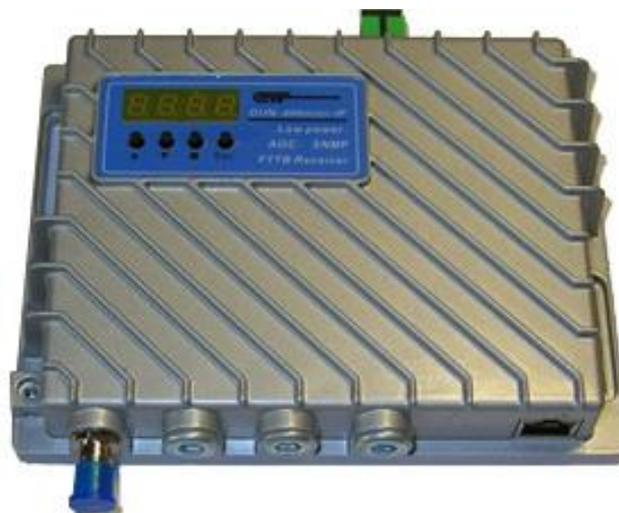
Оптический приемник **ОУК-800mini-Mk2** (далее по тексту «приемник») выполнен в малогабаритном корпусе (163x146x31 мм, вес 0,4 кг) с выносным адаптером питания, 4-х разрядной индикацией и электронной системой управления и контроля.
