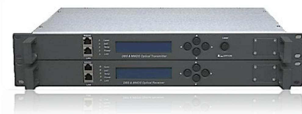
Оптические передатчики спутникового телевидения **серии ОПН-800-1550-xxxx-6SD-SB** (далее по тексту «передатчики») с прямой модуляцией (Direct Modulated) предназначены для модуляции оптического сигнала цифровыми и аналоговыми спутниковыми сигналами L-диапазона (SAT-IF) частотой 950–2600 МГц и передачи его по одному оптоволокну.
