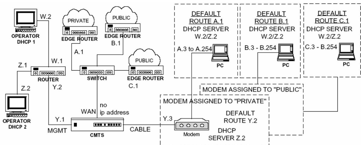
Используется резервирование управляющих серверов для обеспечения надежности подключений клиентов.
