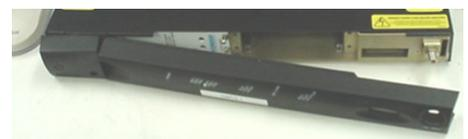
Новая головная станция кабельных модемов Cadant C3 (C3 CMTS) от ARRIS является специальной разработкой для небольших кабельных систем.
