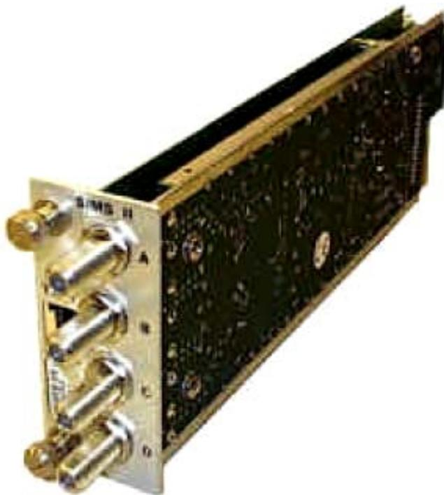
Работает в составе системы мониторинга входов SIMS-II, изолирует входы и анализирует RF спектр обратного канала от оптических узлов (приемо-передатчиков).
