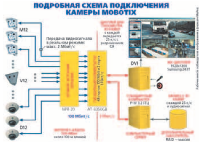
Рис. 6б. Подробная схема подключения камер Mobotix
