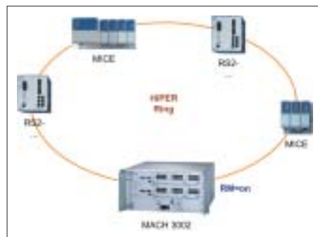
Рис. 2. Подключение коммутаторов Hirschmann по кольцевой технологии Hiper-Ring
