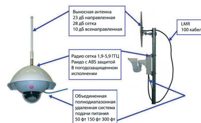
Рис. 7. Схема подключения видеокamер Mobotix к оборудованию AIRAYA Corporation
