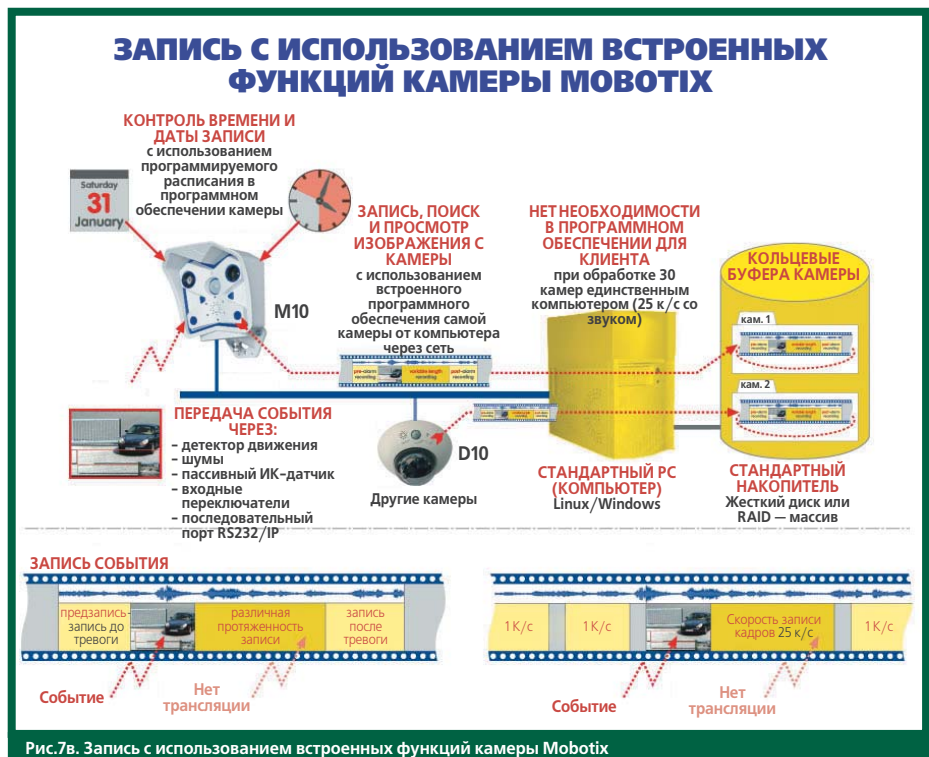
Рис.7в. Запись с использованием встроенных функций камеры Mobotix
