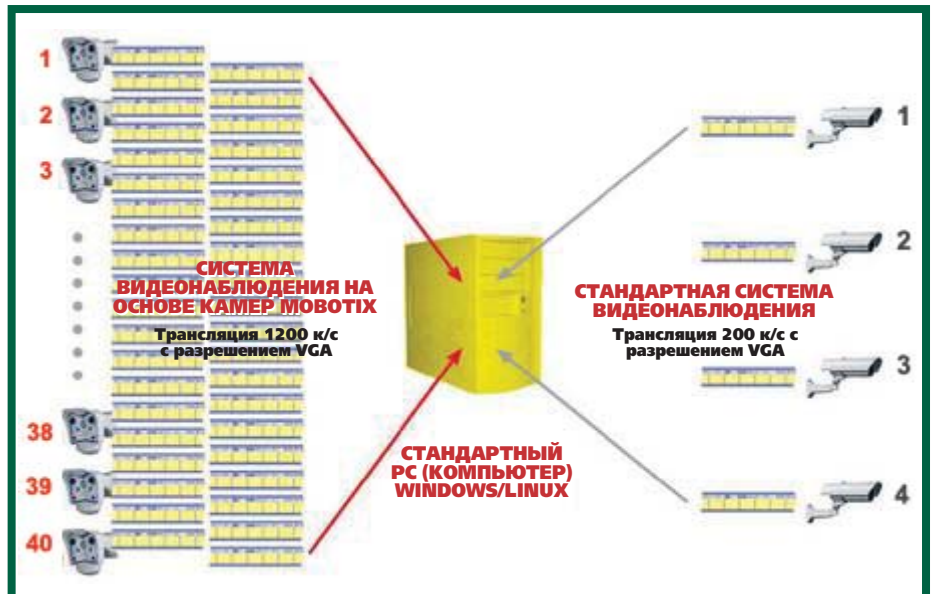
Рис.7а. Структурная схема организации записи с камер Mobotix
