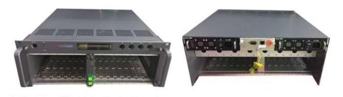
Новая модульная оптическая платформа МОП-16, предназначена для компактной конфигурации функционального оптического приемо-передающего оборудования в стандартную 19" стойку, высотой 4RU.
