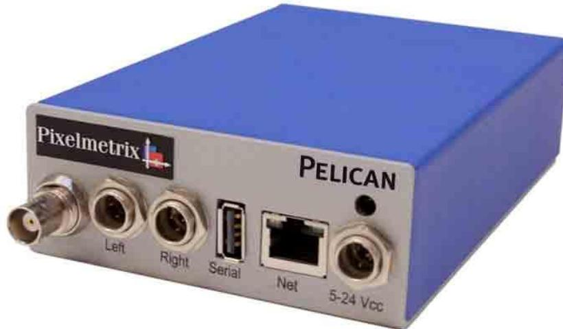
Видеокодер Pelican представляет собой компактное устройство, предназначенное для кодирования в режиме реального времени канала видео совместно с каналом аудио и трансляции его в IP-сеть.
