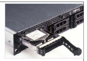
Сменные блоки на задней и передней панели.
